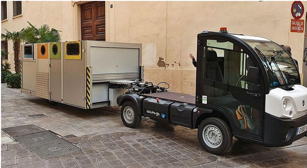
Cuando finaliza el horario de depósito, los remolques son retirados de la calle y transportados hasta el lugar de almacenamiento previsto, en el que son descargados de los residuos en contenedores o directamente en el camión recolector, para estar disponibles para el siguiente día de recogida.
